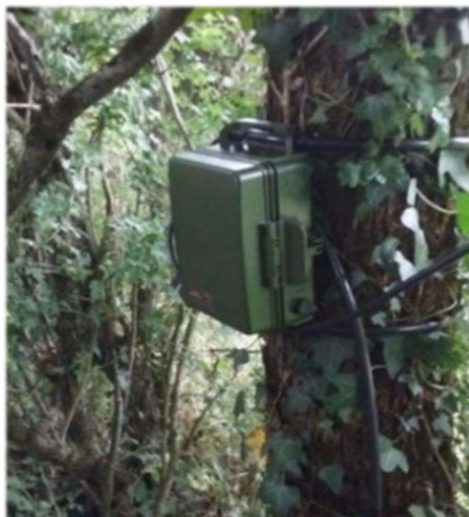
Figure 222 : Exemple d'installation d'enregistreur continu SM4BAT © NCA Environnement (photo prise hors site)
